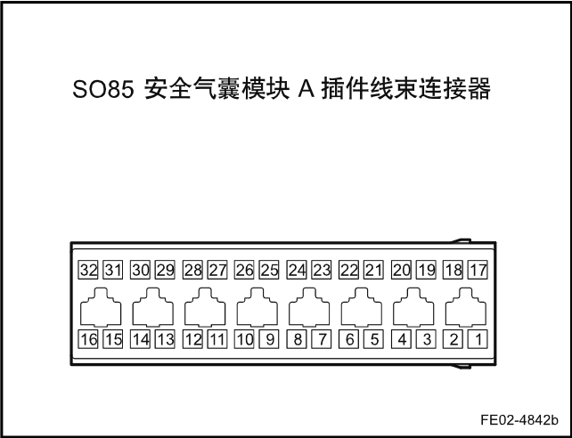
SO85安全气囊模块A插件线束连接器
